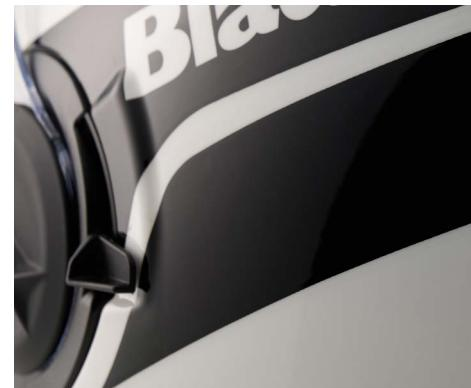
Die Sonnenblende wird abgesenkt, indem man den Schieberegler nach unten drückt.
